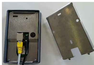
Figures 9b: Raccord de la prise de courant et du câble LAN au dos de l'appareil
